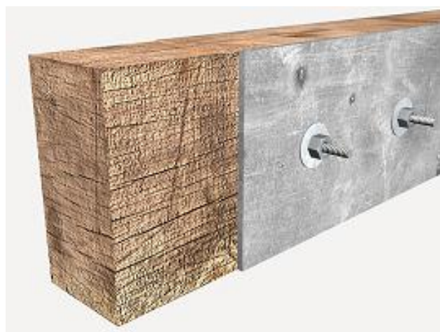
Ilustración 49. Detalle constructivo refuerzo, Generador de precios Cype
