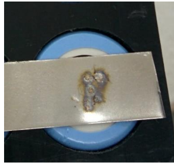
Ilustración 72: Colocación tira y punto correcto
