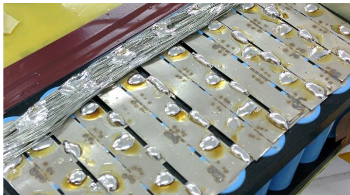
Ilustración 79: Soldadura del borne
