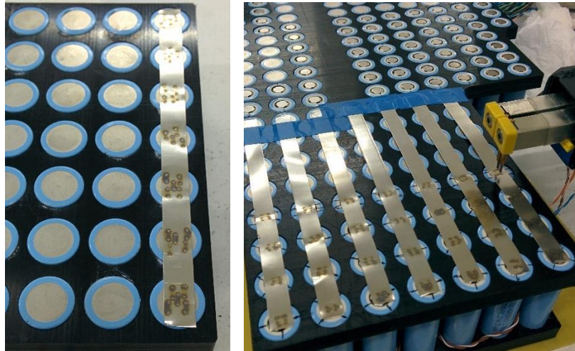
Ilustración 70: Detalle soldadura por puntos
