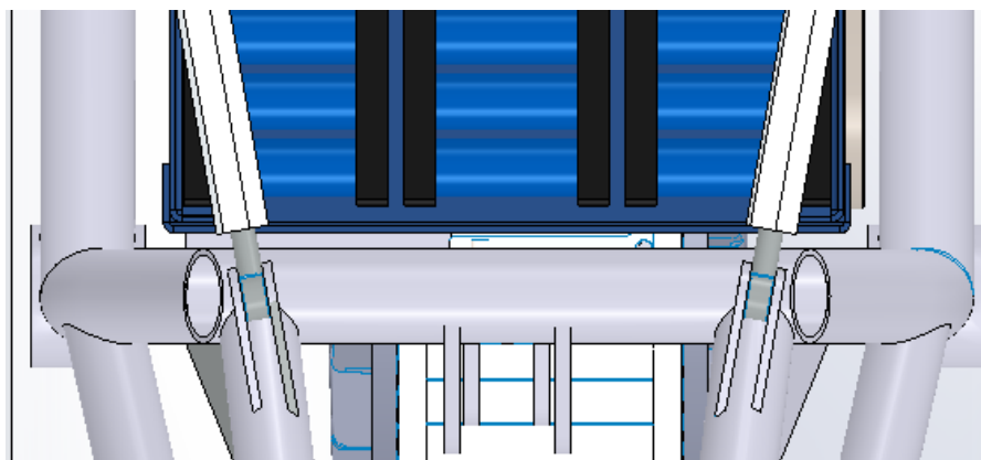
Ilustración 91: Detalle tensores del sistema de suspensión trasero
