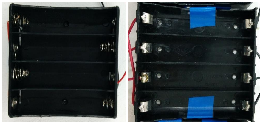
Ilustración 7: Unión por elementos mecánicos
