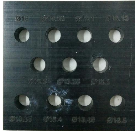
Ilustración 60: Test diámetro mecanizado POM-C
