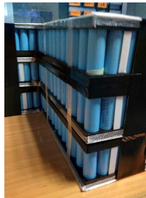
Ilustración 86: Detalle sellado entre bloques
