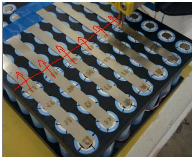
Ilustración 73: Detalle tiras para realizar la conexión serie
