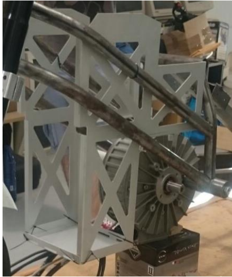
Ilustración 32: Caja acumulador en chasis
