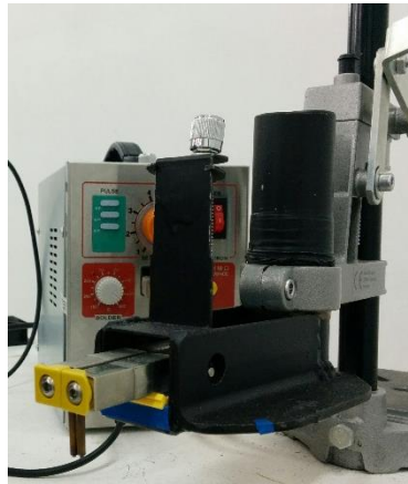
Ilustración 11: Útil para mejorar el soldador por puntos
