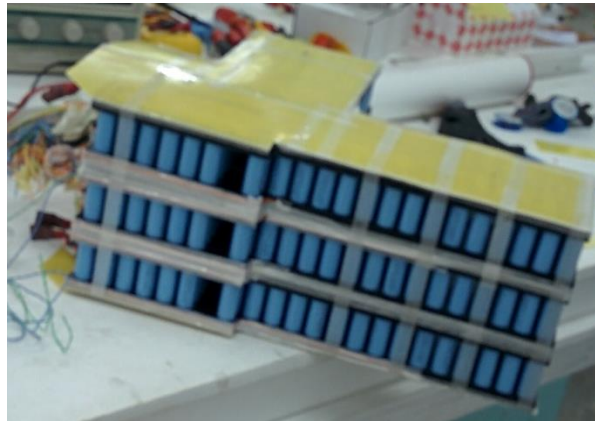
Ilustración 85: Ensamblaje de los 3 módulos
