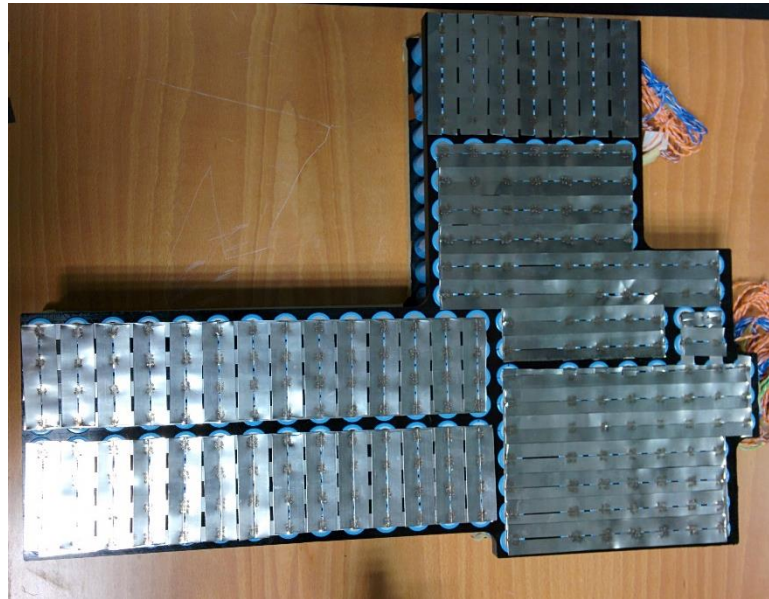
Ilustración 76: Modulo soldado completo
