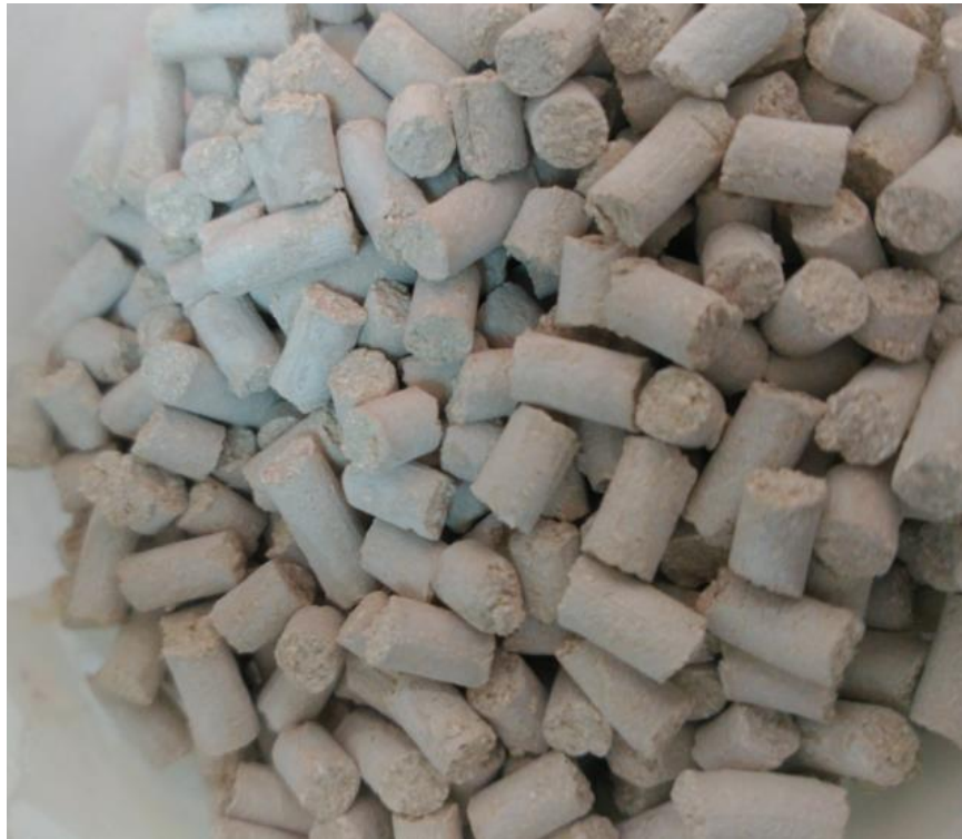
Imagen 1-1. Adsorbente en el interior del filtro.
