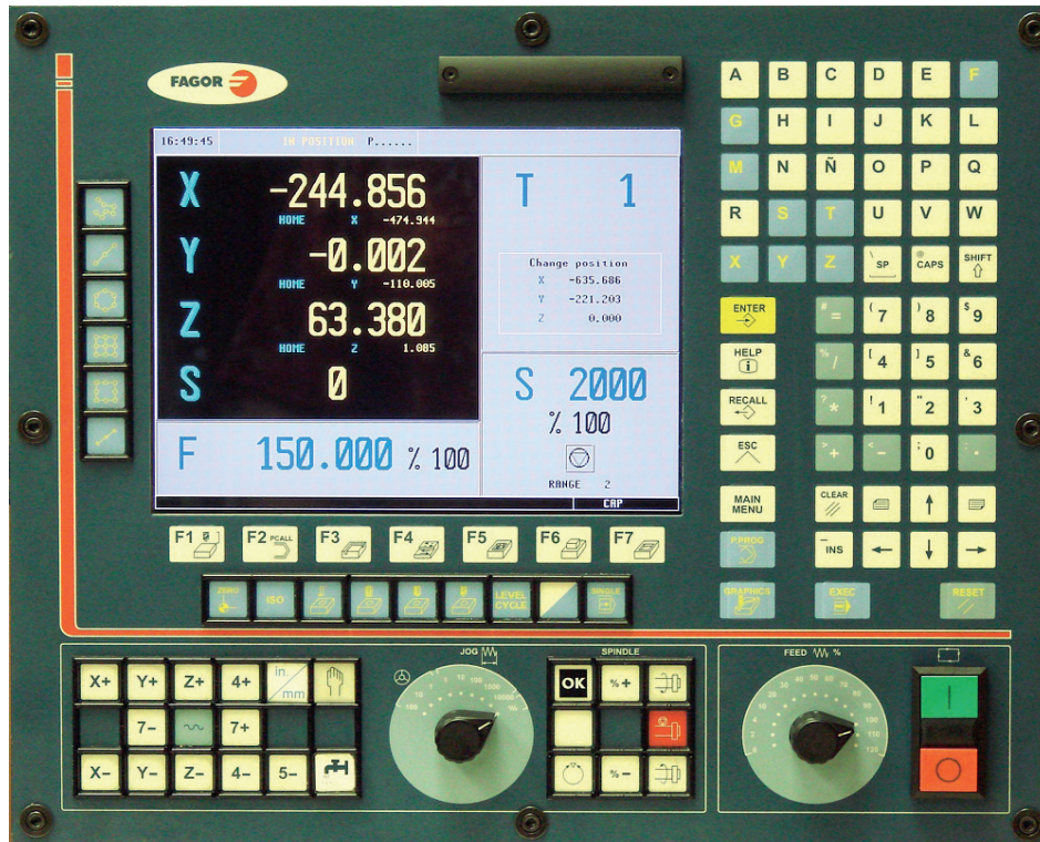
Imagen 133. Control numérico CNC
