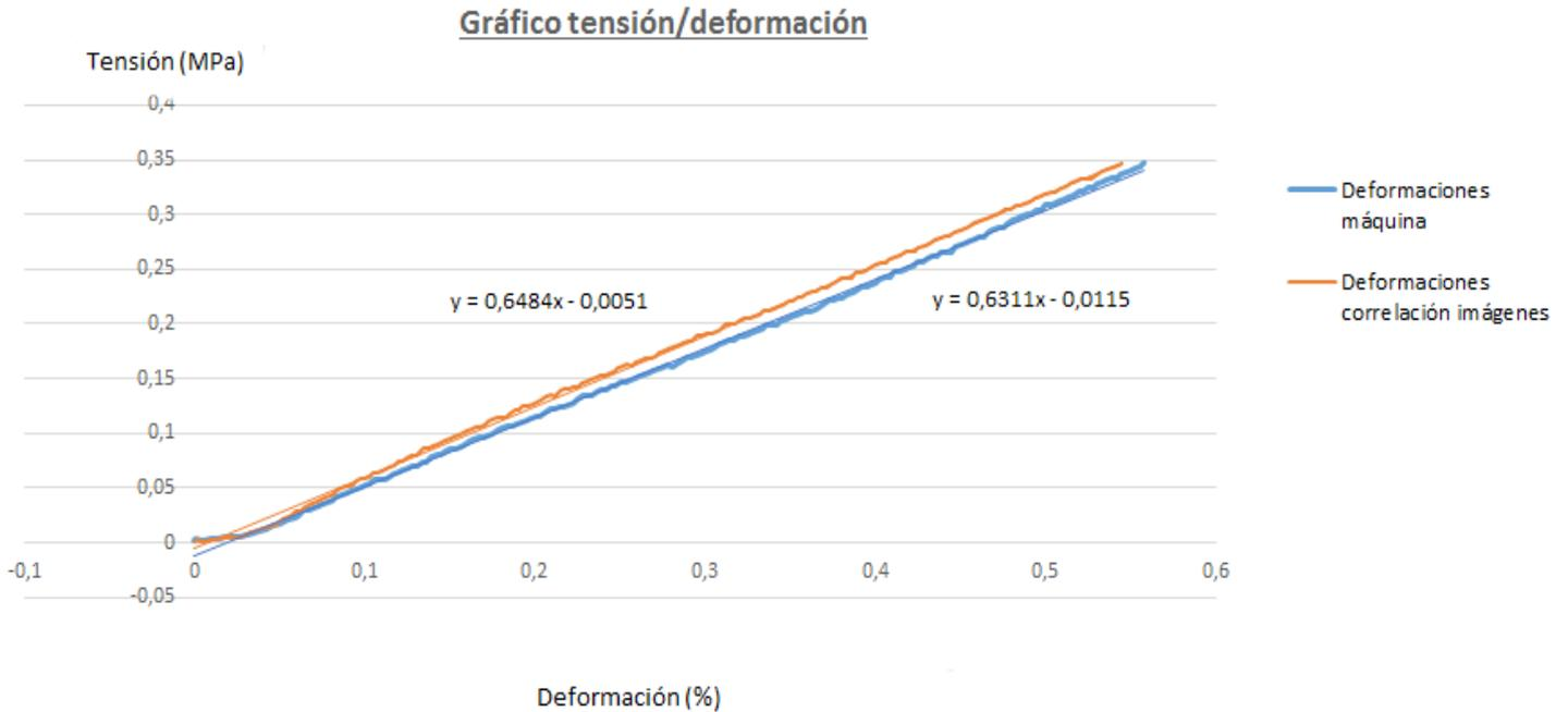
Figura 45: Gráfico tensión deformación de un ensayo de tracción
