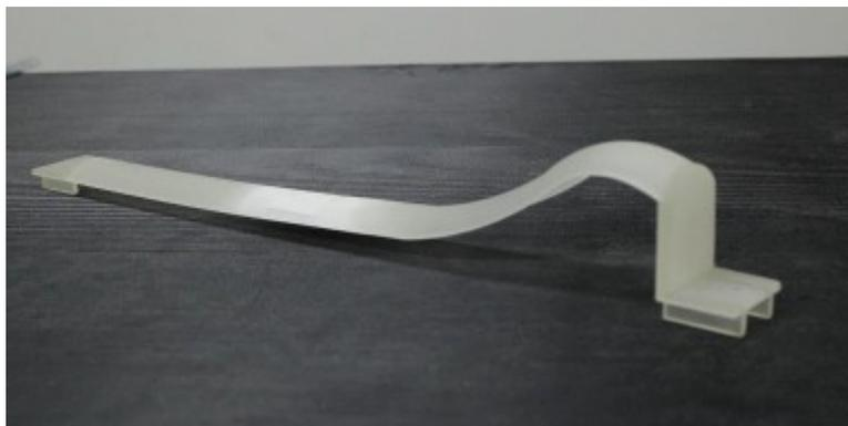
*Figura 20: Soporte para la aorta fabricado por impresión 3D*
