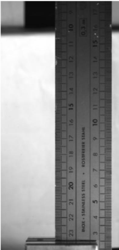
*Figura 54: Regla utilizada como escala para analizar los resultados*
