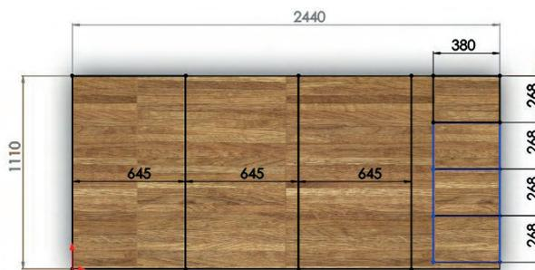
Una vez cortadas las piezas, dará comienzo el mecanizado de cada uno de los tableros, el superior y el inferior, mediante centro de mecanizado.
