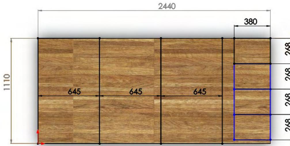
Una vez cortadas las piezas, da comienzo el mecanizado de cada uno de los tableros, el superior y el inferior, mediante un centro de mecanizado. Para observar las zonas mecanizadas en cada paso, se muestran imágenes a continuación en las que se indica mediante colores, la geometría cortada en cada paso. Aunque el tablero que se comercializa posee unas dimensiones fijas, toda la madera se aprovecha ya que el escritorio AD está pensado para ser complementado por objetos del mismo material.
