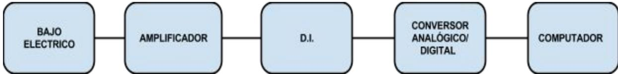
Esquema de la captación del bajo con D.I..
