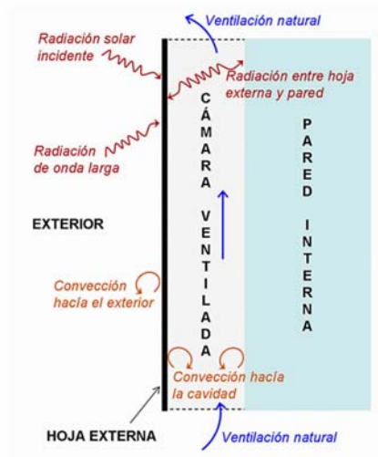
Esquema funcionamiento módulo "Exterior Naturally Vented Cavity"
