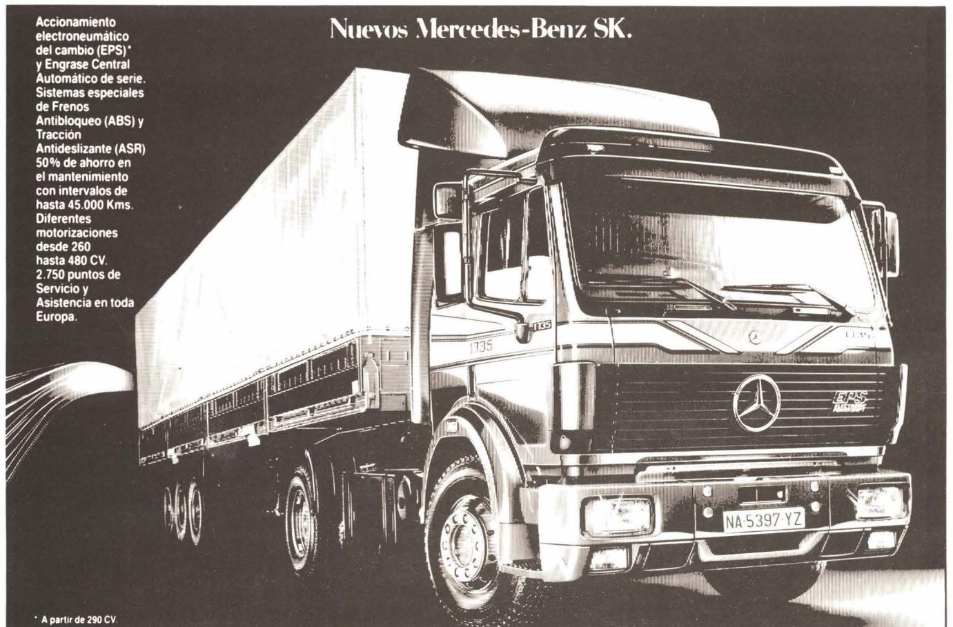
Accionamiento electroneumático del cambio (EPS)\* y Engrase Central Automático de serie. Sistemas especiales de Frenos Antibloqueo (ABS) y Tracción Antideslizante (ASR) 50% de ahorro en el mantenimiento con intervalos de hasta 45.000 Kms. Diferentes motorizaciones desde 260 hasta 480 CV. 2.750 puntos de Servicio y Asistencia en toda Europa.
