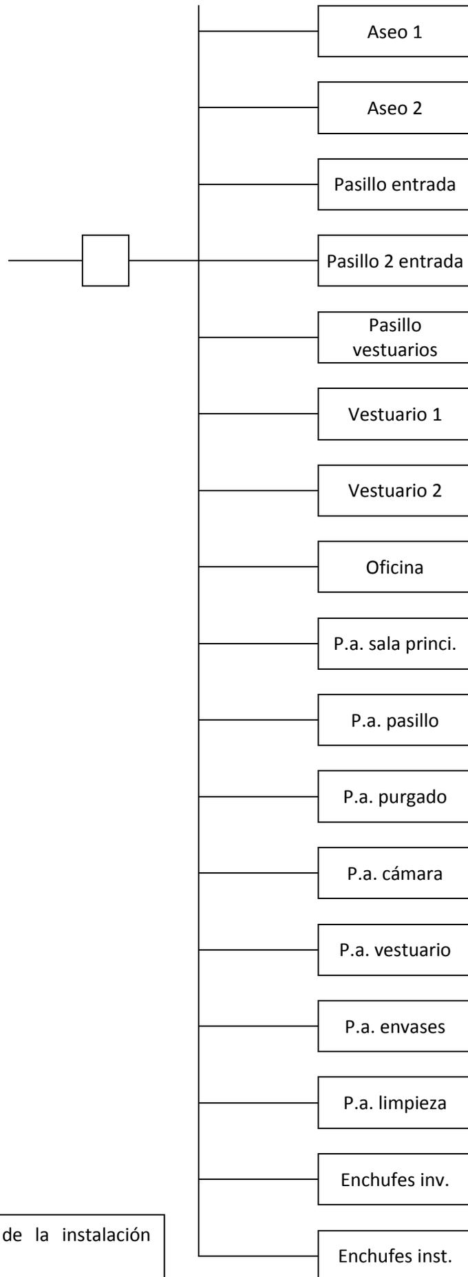
Fig. 13. Líneas de la instalación eléctrica.
