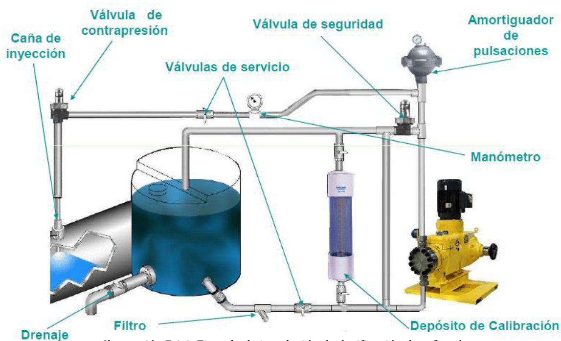
Ilustración 7.1.1. Ejemplo de instalación de dosificación de refinería
