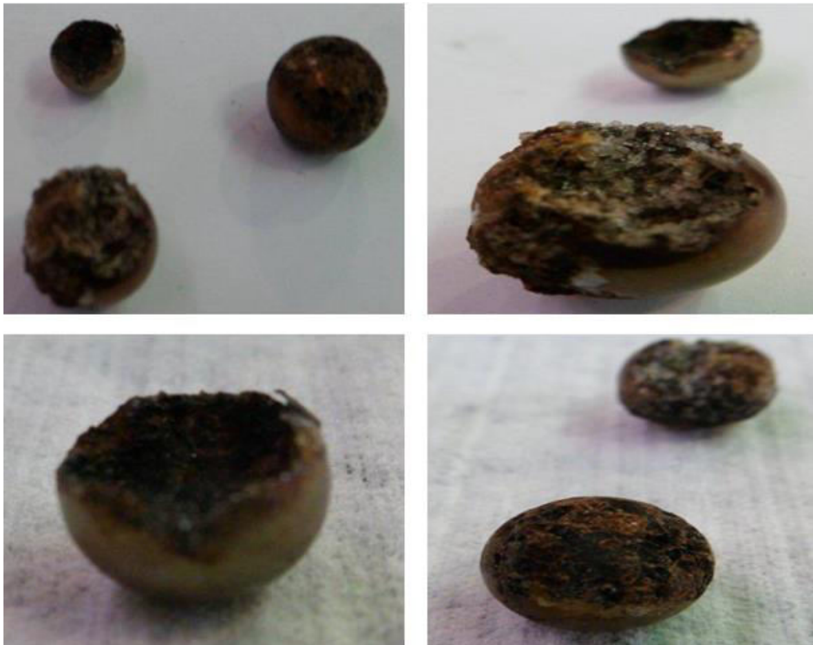
Ilustración 14.1. Bolas de válvulas de bomba dosificadora deterioradas por el fluido bombeado
