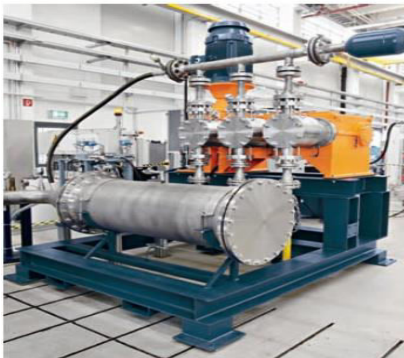
Ilustración 19.1. Imagen del banco de pruebas Milton Roy ofertado
