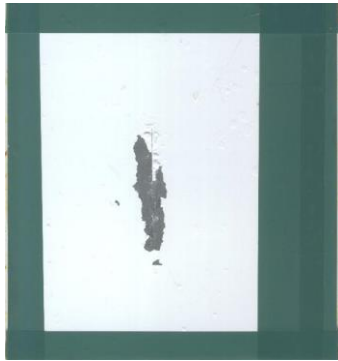
Ilustración 74. Evaluación de la adherencia en la incisión en el pigmento UJI 004.
