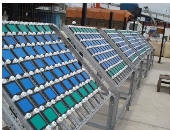
Ilustración 28. Ensayo de exposición atmosférica.
