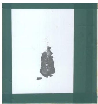
Ilustración 72. Evaluación de la adherencia en la incisión en el blanco.
