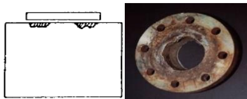
Ilustración 7. Esquema de la zona de ataque y ejemplo de corrosión por hendiduras.
