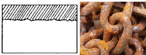
Ilustración 1. Esquema de la zona de ataque y ejemplo de corrosión uniforme.
