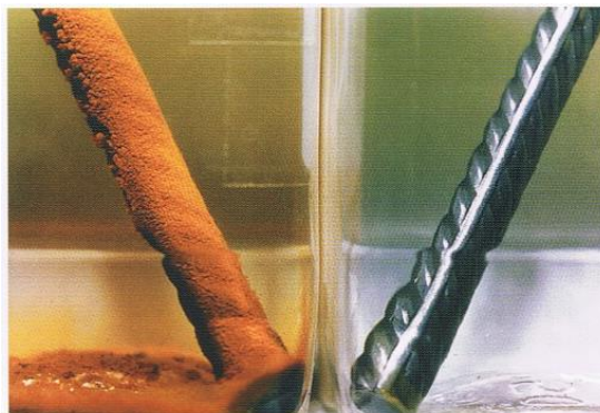
Ilustración 24. Efecto de un inhibidor de la corrosión. 30
