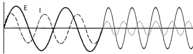
Ilustración 31. Esquema de la forma que toma el potencial y su respuesta en intensidad.
