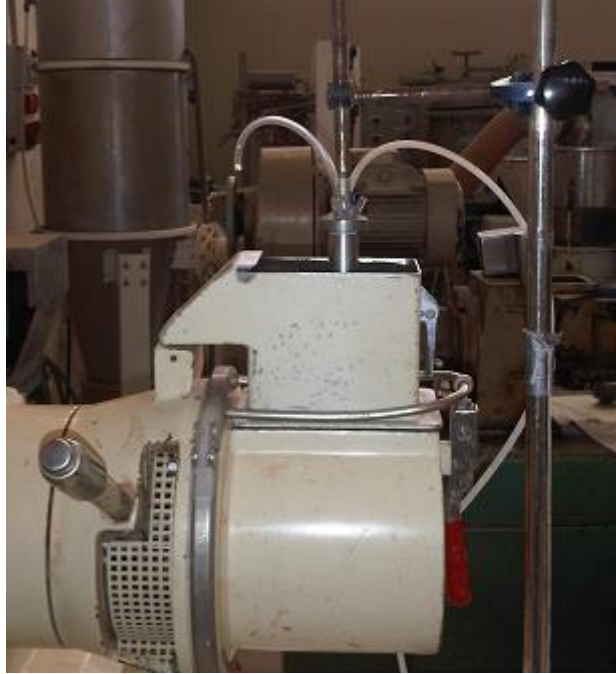
Figura 14: Montaje de la boquilla para pulverizar el aglutinante
