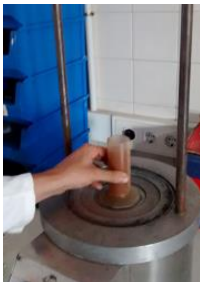
Figura 18: Ensayo de compactación de lecho
