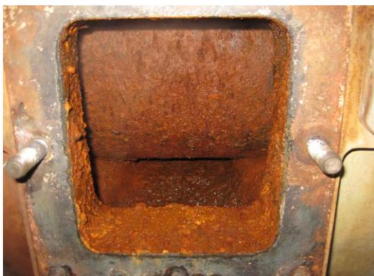
(b) Cubierta de una válvula.
