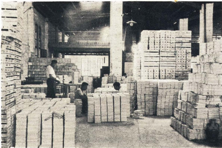
Sección de clasificación y entonación del azulejo
