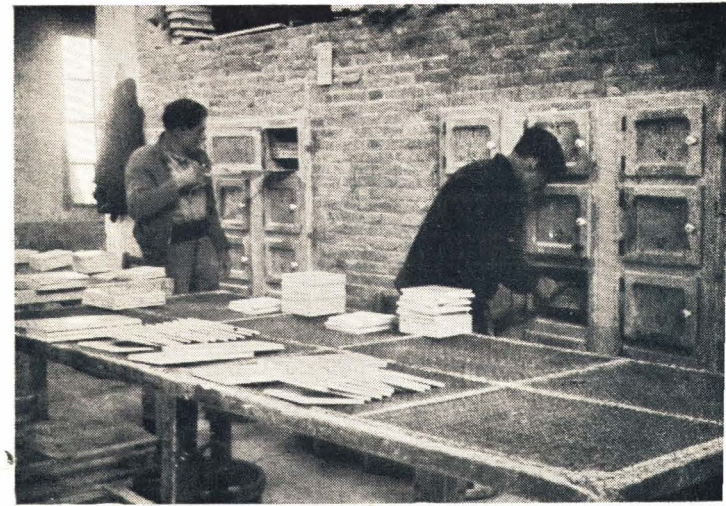
De arriba a abajo: Horno de parajes. Momento de introducir el "bizcocho" barnizado, y momento de sacar del mismo el azulejo ya terminado
