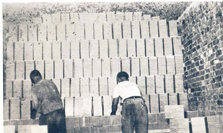
De izquierda a derecha: Después de prensados los azulejos, se extienden para que se sequen. Cargando el azulejo en el horno para su cocción. (Una vez cocida la pieza, se llama "azulejo en bizcocho")
