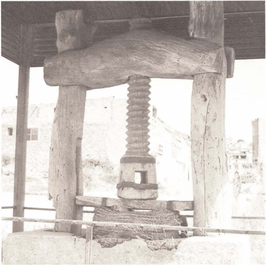
Prensa de madera a tornillo, frente a la Bodega de Cabanes
