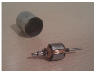
Il·lustració 2: Motor elèctric desmuntat
