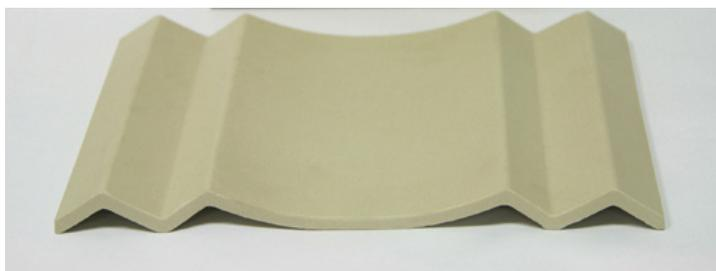
**Imagen 1.1:** Pieza en verde del colector solar
