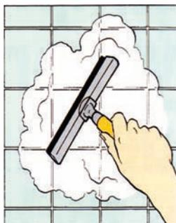
**Imagen 4.4:** Colocación de lechada sobre la pared
