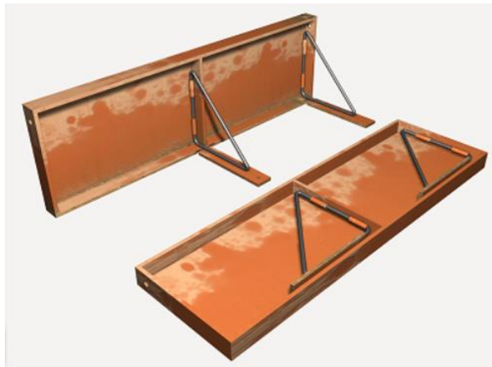
Ilustración 126. sistema de encofrado primera etapa
