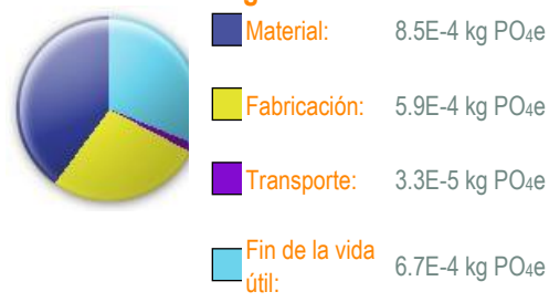
Ilustración 47. Resultados impacto madera
