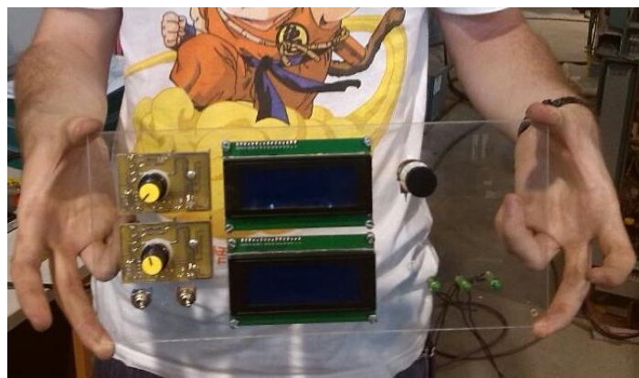
Ilustración 44 - Imagen de las 2 LCD, los reguladores de los ventiladores y los interruptores de los LEDs.
