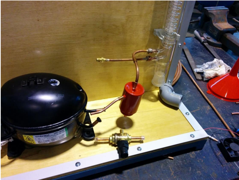
Ilustración 41 - Colocación y medición del depósito y la válvula
