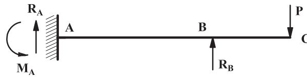
Fig. 6.30. Exemple 6.12. Sistema isostàtic estàticament equivalent
