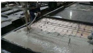
Figura 4.11: Proceso fabricación panel aligerado sin puente térmico, Ref. THERMOMASS
