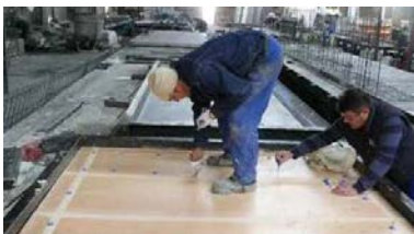
Figura 4.11: Proceso fabricación panel aligerado sin puente térmico, Ref. THERMOMASS
