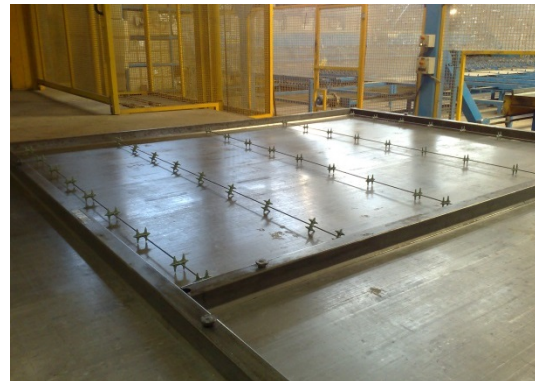
Figura 4.22: Colocación costeros para delimitar la superficie del elemento. Ref. PAVI
