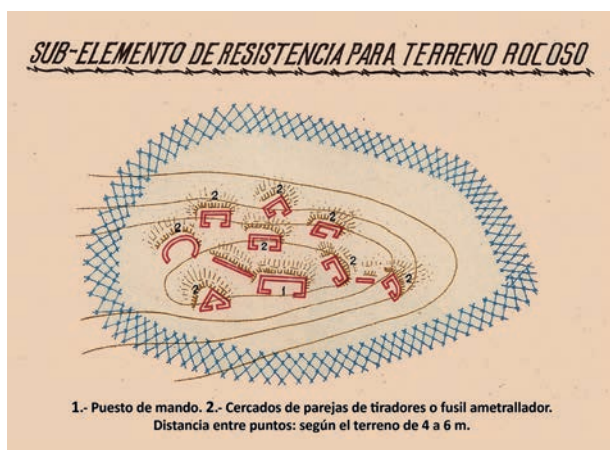
Figura 4. Esquema de un sub-elemento de resistencia similar al documentado en Morella. (ABC de la batalla defensiva).
