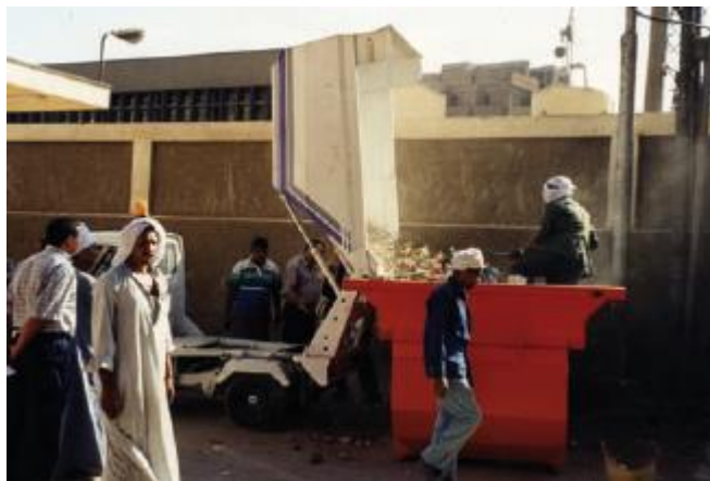
Imagen 35: Descarg de un vehículo satélite a un punto de transferencia de mayor capacidad. Fuente: (UN-HABITAT, Collection of Municipal Solid Waste in Developing Countries, 2010)
