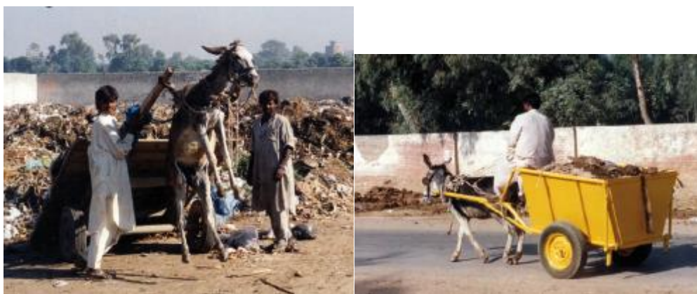
Imagen 28: Mejora de los carros por tracción animal en Pakistán. A la izquierda se muestra el problema existente con los animales a la hora de descargar los residuos. A la derecha la solución finalmente adaptada. Fuente: (UN-HABITAT, SOLID WASTE MANAGEMENT IN THE WORLD'S CITIES. WATER AND SANITATION IN THE WORLD'S CITIES, 2010)
