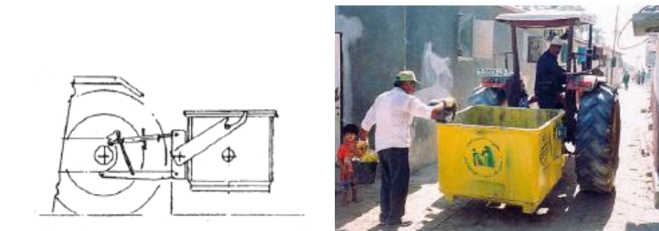
Imagen 38: Tractor con un contenedor acoplado a la parte trasera. Fuente: (UN-HABITAT, Collection of Municipal Solid Waste in Developing Countries, 2010 )
