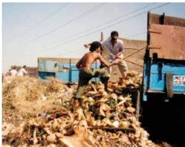
Imagen 42: Descarga manual de un camión sin posibilidad de inclinar la carga. Fuente: (UN-HABITAT, Collection of Municipal Solid Waste in Developing Countries, 2010)
