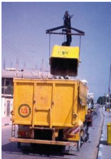
Imagen 47: Camión con grúa incorporada para la descarga de residuos. Fuente: (UN-HABITAT, Collection of Municipal Solid Waste in Developing Countries, 2010 )
