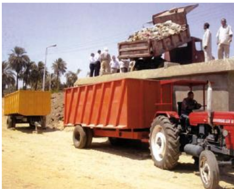
Imagen 59: Descarga directamente al camión mediante la transferencia de nivel dividido. Fuente: (UN-HABITAT, Collection of Municipal Solid Waste in Developing Countries , 2010)
