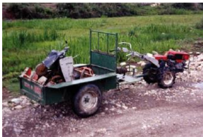
Imagen 29: Motocultor adaptado a la recolección de residuos. Fuente: (UN-HABITAT, Collection of Municipal Solid Waste in Developing Countries, 2010)
