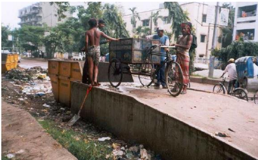
Imagen 58: Descarga directamente a un contenedor mediante la transferencia de nivel dividido en Bangladesh. Fuente: (UN-HABITAT, Collection of Municipal Solid Waste in Developing Countries , 2010)
