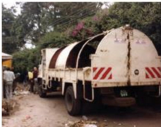
Imagen 43: Ejemplo de camión de carga lateral roll-top. Fuente: (UN-HABITAT, Collection of Municipal Solid Waste in Developing Countries, 2010 )
