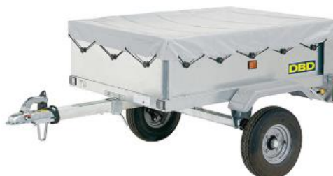
Imagen 64: Lona para el remolque con el fin de evitar la caída de objetos que se encuentren dentro de éste cuando el vehículo está en movimiento.
