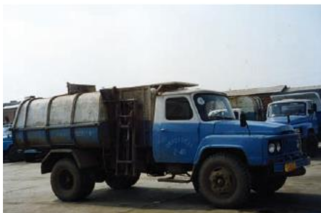
Imagen 46: Camiones de carga de residuos lateral. Fuente: (UN-HABITAT, Collection of Municipal Solid Waste in Developing Countries, 2010 )
