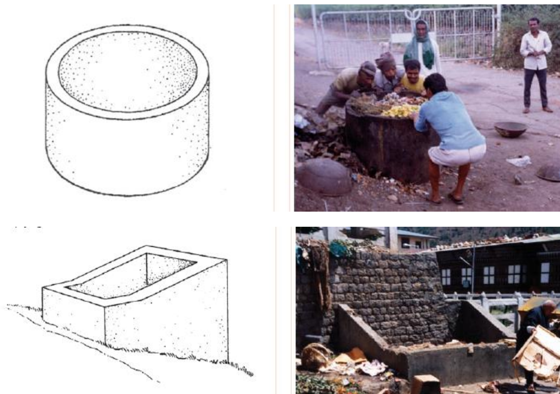
Imagen 53: Depósitos fijos comunitarios. Fuente: (UN-HABITAT, Collection of Municipal Solid Waste in Developing Countries, 2010 )
