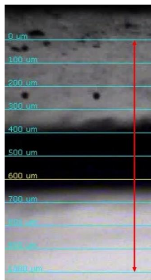
Ilustración 13: Medición de la velocidad de eyección de gotas
