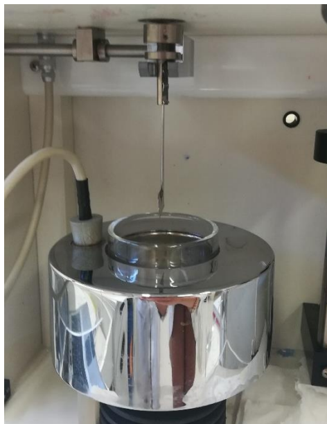
Ilustración 11: Aparato de medida de energía superficial de un líquido
