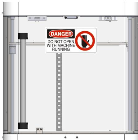
Figura 138: aviso restrictivo contra la apertura de la puerta durante el funcionamiento automático de la máquina.
