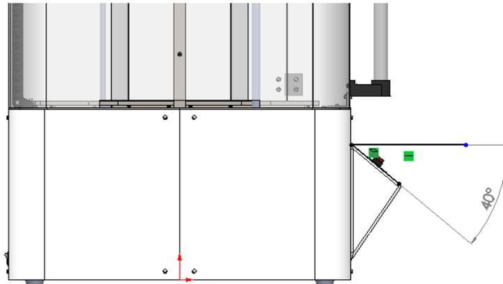
Figura 147. inclinación de la pantalla respecto a la horizontal.
