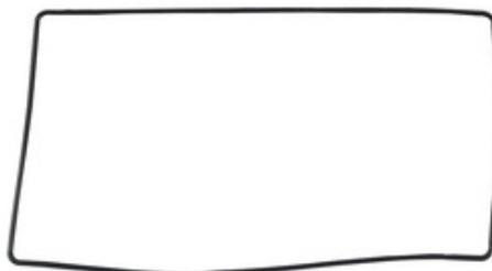
Figura 169: junta cuadrada de sección rectangular.
