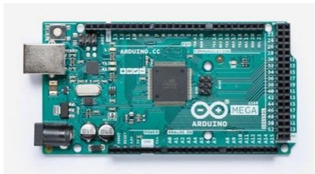
Figura 166: controlador Arduino Mega.
