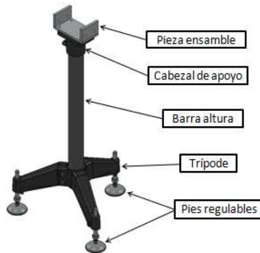
Fig. 31 Componentes del pie del transportador
