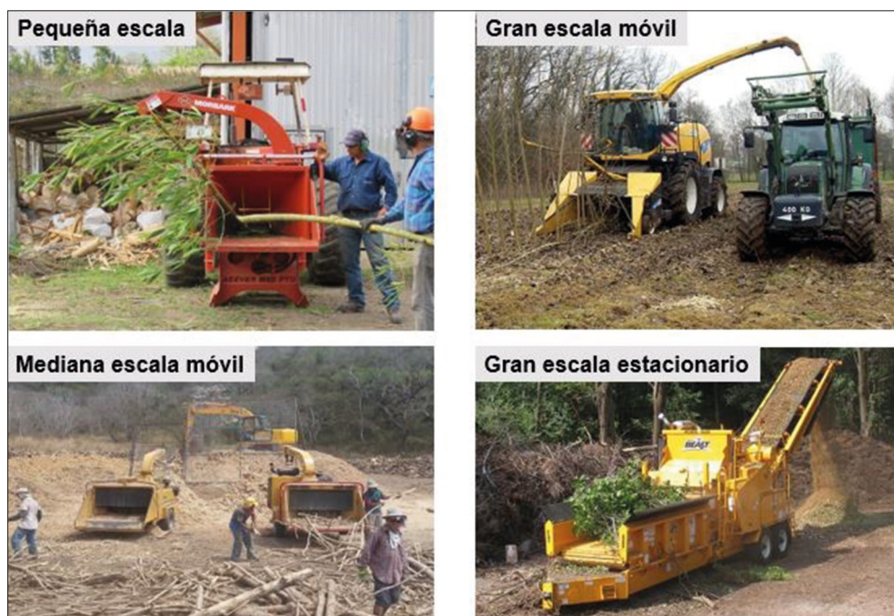
FIGURA 2.2.5. Escala de los equipos de transformación de la biomasa en astillas.
