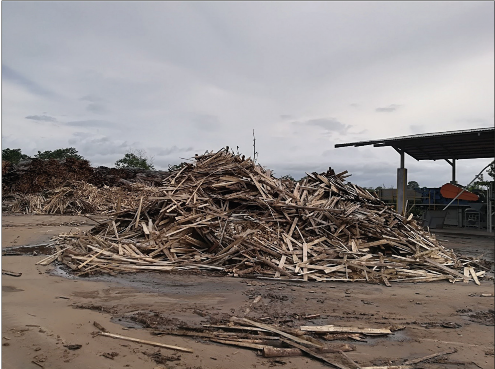
FIGURA 2.2.8. Residuos de aserradero en espera de su transformación con posibilidades de uso como leña o mediante un proceso más elaborado poder llegar hasta pellets.
