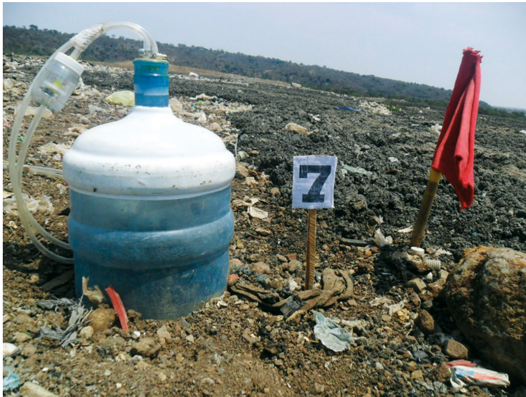
FIGURA 5.2.2. Cámara estática utilizada para la cuantificación de emisiones superficiales de metano en el sitio de estudio.
