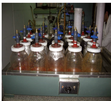
FIGURA 4.3.2. Disposición de reactores de PET en baño termostático. Producción acumulada de biogás en ensayo. Detalle de reinoculación.
