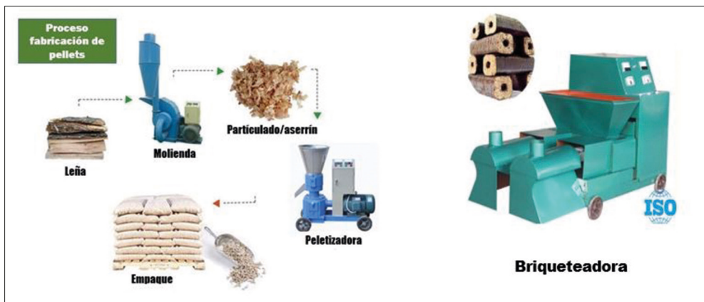
FIGURA 2.2.6. Proceso de fabricación de pellets y briquetas a pequeña escala.
