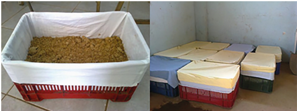
FIGURA 3.2.1. Unidad experimental con inóculo de Takakura (izquierda), diseño experimental. 2 tratamientos y 5 repeticiones por tratamiento (derecha).
