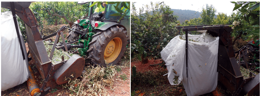
FIGURA 3.1.4. Triturado en campo de la materia prima y almacenamiento en bigbags .
