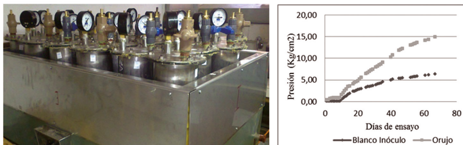
FIGURA 4.3.3. Reactores de acero inoxidable, provistos de manómetros en baño termostático. Presión acumulada de biogás en reactores.
