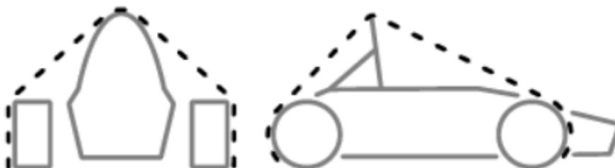
*Ilustración 46: Zona de restricción del sistema de admisión y combustible.*
