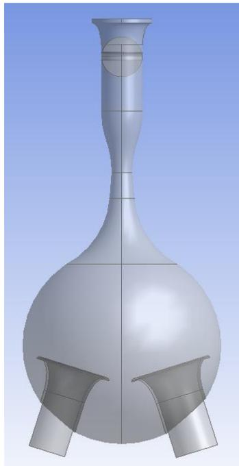
*Ilustración 67: Modelado con trompeta y difusor*
