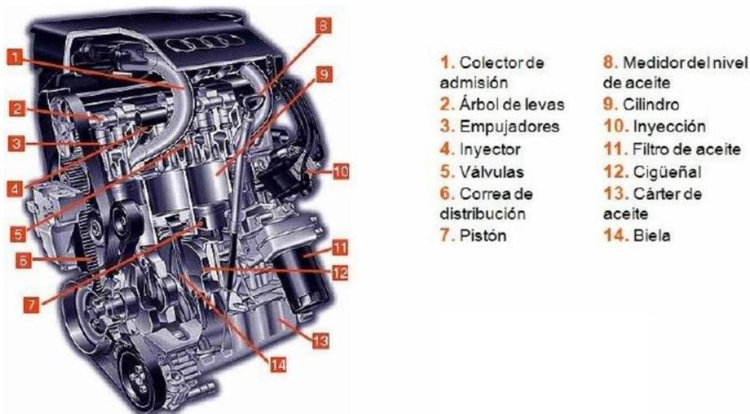
*Ilustración 3: Componentes de un Motor de Combustión Interna Alternativo (MCI)*
