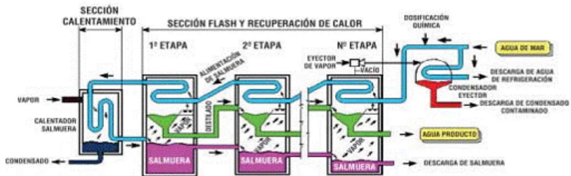
Figura 6. Esquema del método destilación súbita tipo flash multietapa. Fuente : Colegio de Ingenieros de Caminos Canales y Puertos. Francisco Urrutia. "Evolución global de la capacidad de plantas desaladoras"
