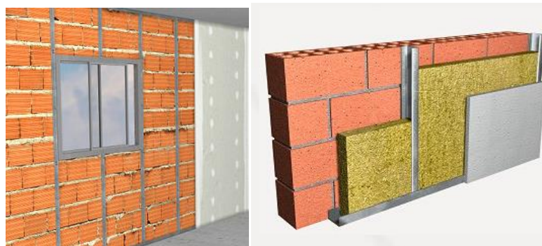
Figura 56. Imagen de trasdosado por el interior de placas de yeso laminado con un aislamiento térmico de lana mineral (Fuente: generador de precios de cype)
