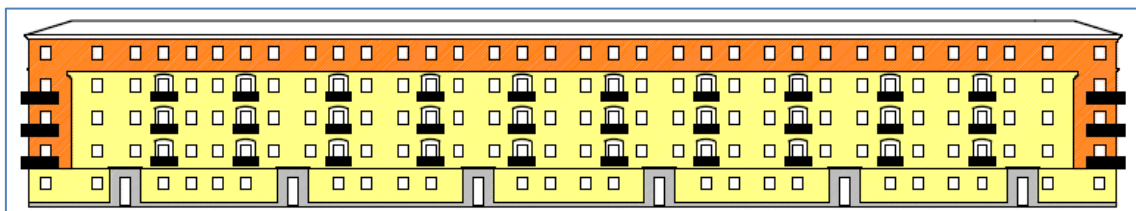
Figura 31. Imagen distribución de fachadas por tipologías en Fachadas Norte y Sur (amarillo revestida, naranja caravista y gris zócalo).
