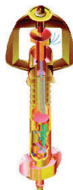
El diafragma de silicona inyectada recibe la presión de entrada por ambos lados
