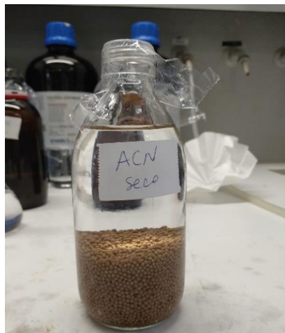
Figura 17. Ejemplo de cómo se secaba el acetonitrilo con el tamiz molecular de 3 Å.
