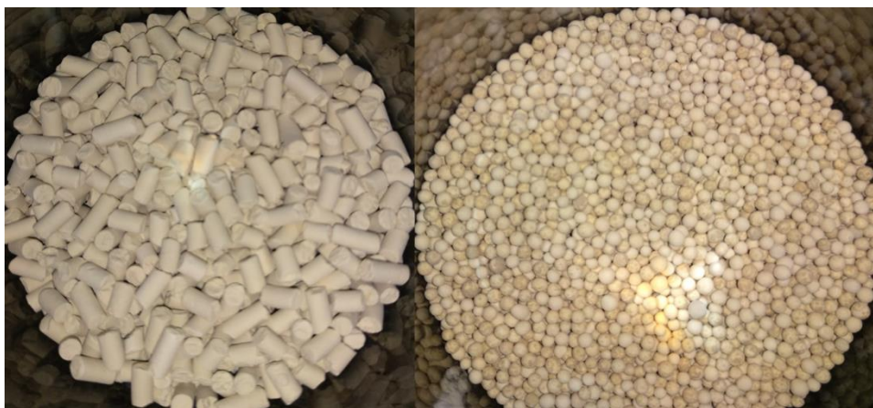
Figura 16. Tamices moleculares, de tamaño de poro distinto, el de la izquierda es de 5 Å y el de la derecha de 3 Å.
