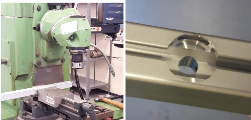
Figura 44. IZDA: Operación de taladrado; DCHA: Resultado
