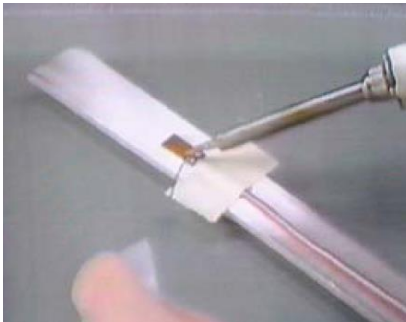
soldar los cables a la galga
