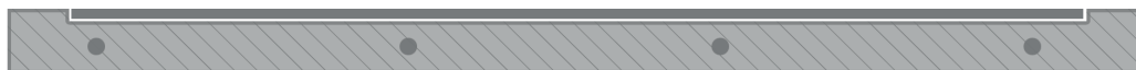
Sección de la propuesta-1 donde se muestran los cuatro elementos metálicos en el interior de la base, que aportan la plasticidad al conjunto.
