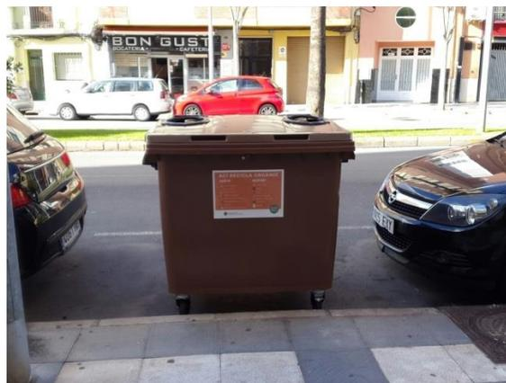
**Figura 2. Contenedor de 1.100 L para la recogida selectiva de la FORSU**
