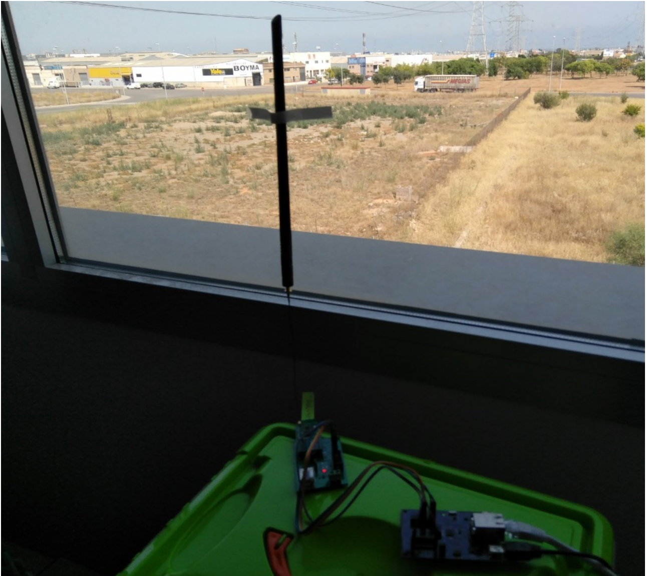
Figura 6.62: Border Router (Openchina) conectado a antena de alta ganancia
