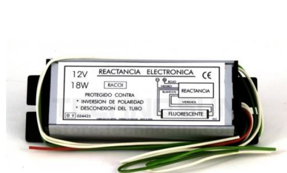
Fig. 99 ( store.technosun.com ): També hi ha reactàncies electròniques, que no tenen potència reactiva i no necessiten de encebador, però no funcionen en tots els tubs LED.
