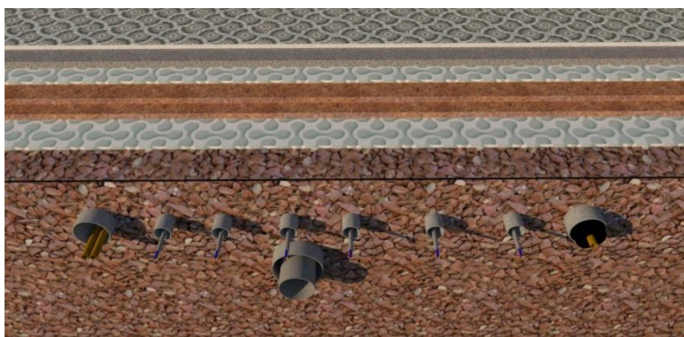
Fig. 76 (Font pròpia): Simulació de l'aspecte de la nova solera amb aïllament tèrmic.
