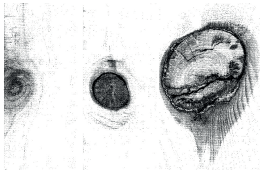
Imagen de un nudo sano, otro saltadizo y uno podrido (de izquierda a derecha).
