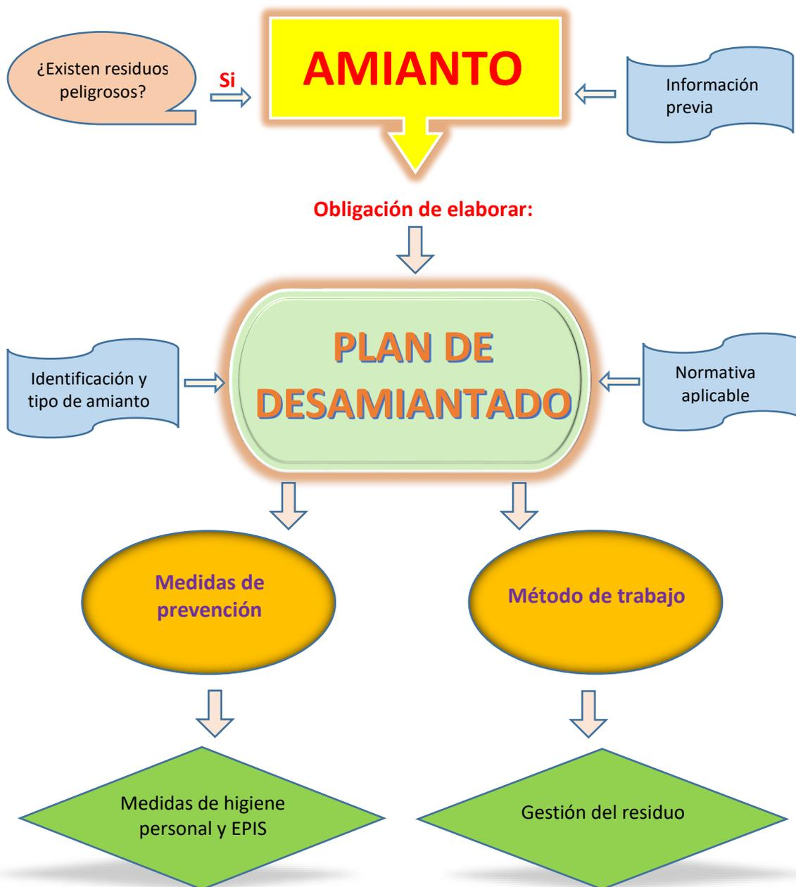
Figura 3. Diagrama de flujo Amianto
