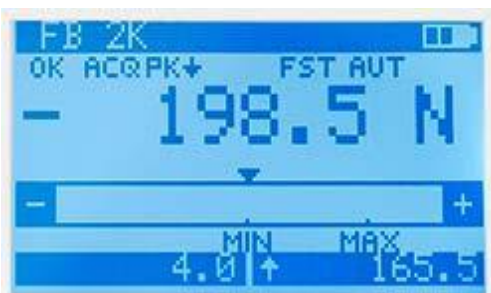
Pantalla del dinamómetro con información como fecha, hora, estado de batería, velocidad de medición, fuerza y valores máximo y mínimo
