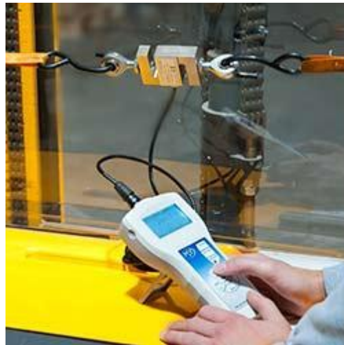
Dinamómetro de precisión PCE-FB K con célula de carga externa para fuerzas de tracción y compresión
