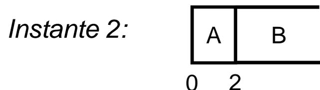
Se produce una expulsión de la CPU del proceso A.
