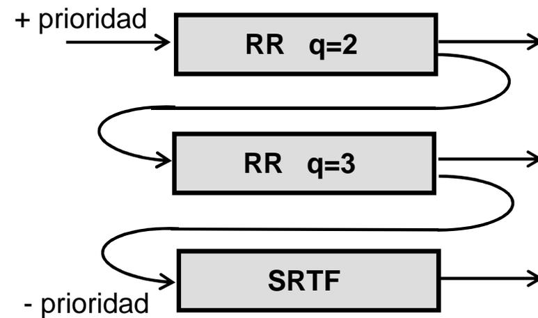
El sistema operativo utiliza un algoritmo de planificación con 3 colas multinivel con prioridad expulsiva con las características indicadas en el esquema de arriba.
