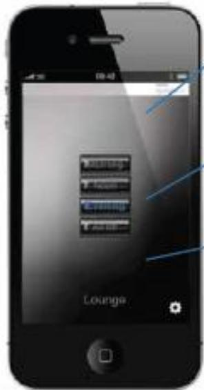
Los niveles de iluminación individuales pueden regularse fácilmente y después memorizarse en un botón para recuperarlos más adelante. Estos ajustes posteriormente se guardan en una botones de control local de la sala para facilitar la edición de los niveles de iluminación del sistema.
