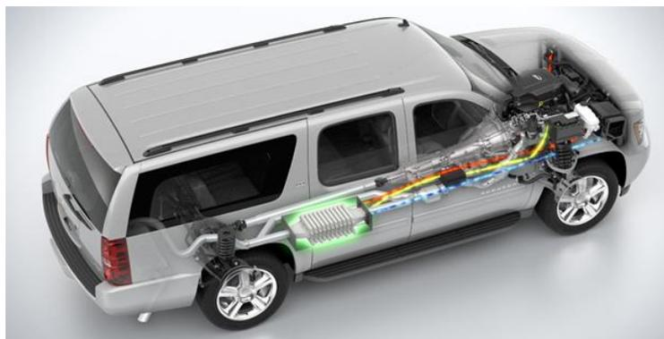
**Fig. 7.** Simulación de un recuperador termoeléctrico montado en un Chevrolet Suburban [11].
