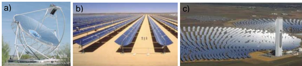
Figura 4: Colectores para CSP. a) Discos parabólicos. b) Cilindro-parabólicos. c) Torres solares. [9]
