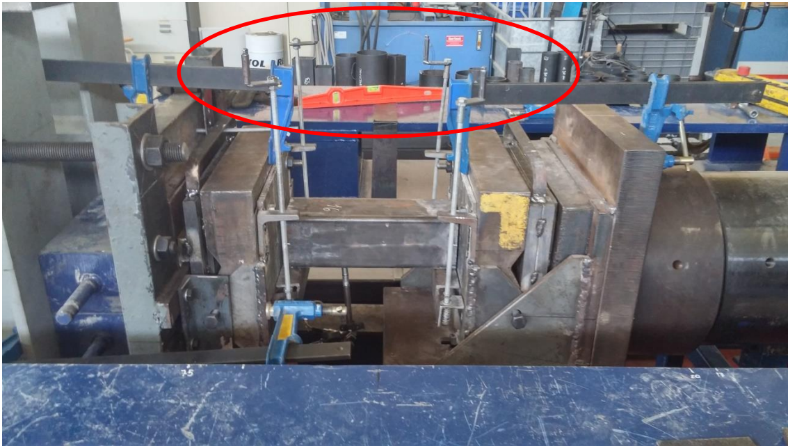
Ilustración 25 Zoom del pórtico al sistema para ajustar la excentricidad
