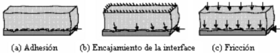
Ilustración 11 Mecanismos de adherencia entre el acero y el hormigón
