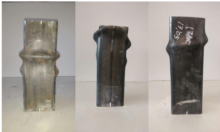
Ilustración 37 Pilares mixtos ya ensayados
