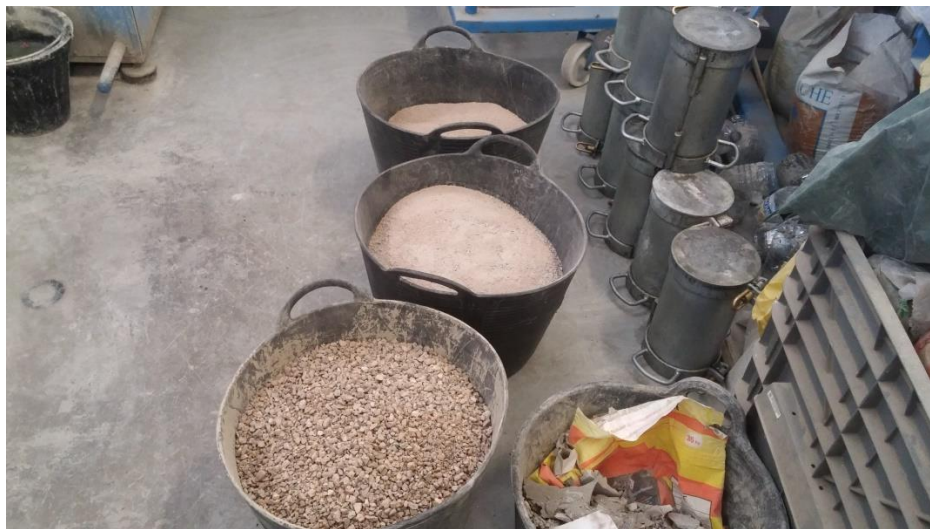
Ilustración 23 Dosificación preparada para la fabricación del hormigón
