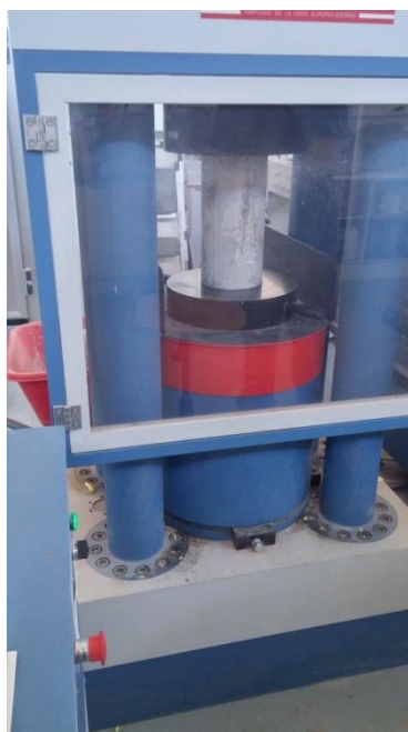
Ilustración 30 Sistema para ensayar probetas cilíndricas de hormigón
