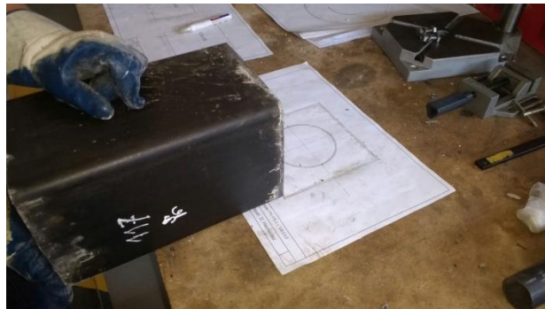
Ilustración 31 Marcado de pilares 1
