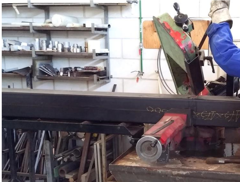
Ilustración 22 Corte de los perfiles de acero a la longitud de 300 mm
