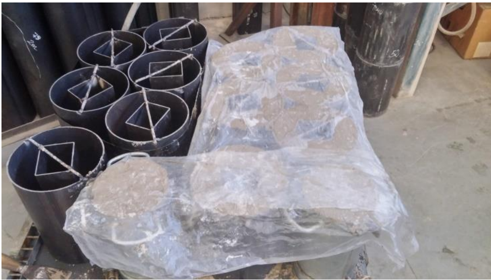
Ilustración 21 Plástico utilizado para cubrir las probetas para que no pierdan humedad
