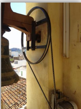
En la imagen se observa el mecanismo de giro de la campana.
