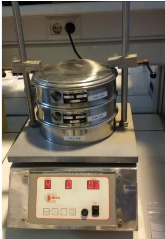
Figura 15. Tamizado mecánico.
