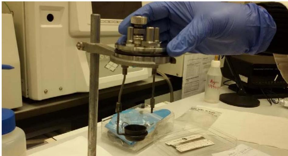
Figura 12. Cápsula con el hilo de ignición.
