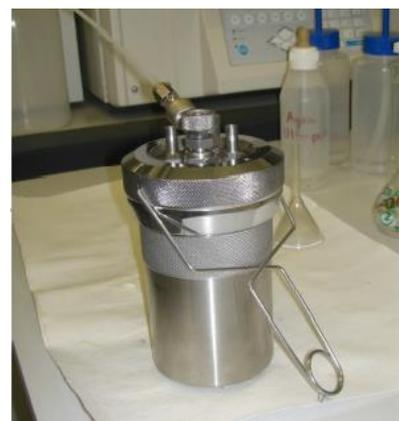
Figura 13. Carga y llenado de la bomba con O<sub>2</sub>.
