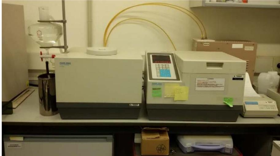
Figura 14. Calorímetro isoperibólico.
