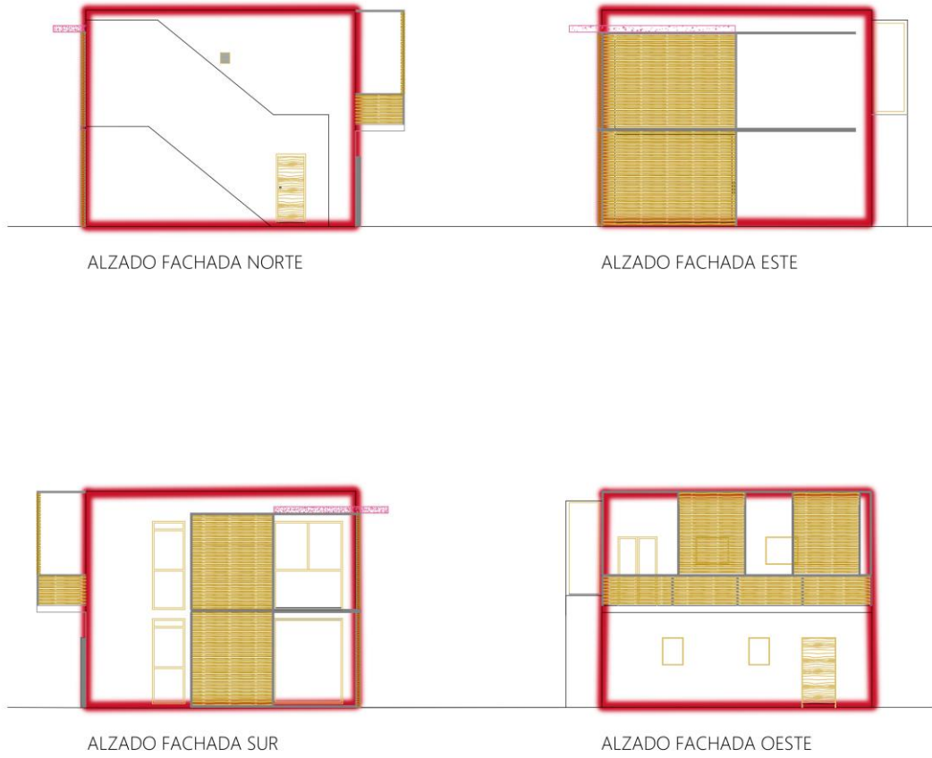
Figura 52. Alzados de la vivienda donde se indica la envolvente térmica.
