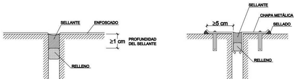
Figura 44. Imagen tipo de junta de dilatación con sus componentes. Figura 2.6 CTE DB-HS1
