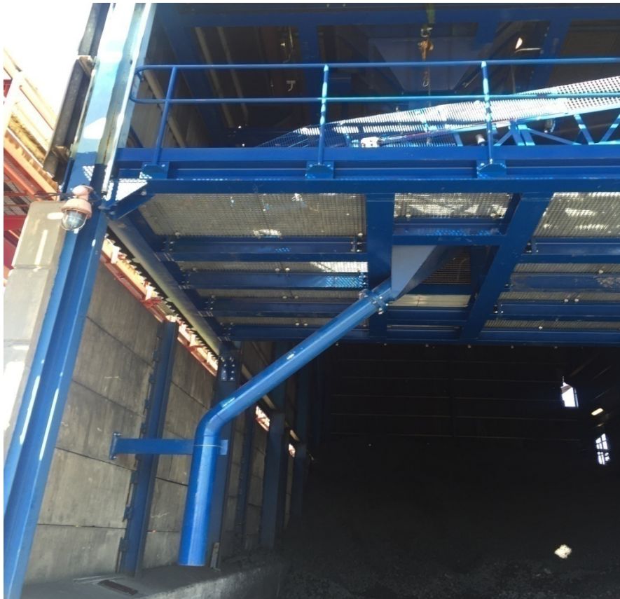
Ilustración 10. Recogida de material rechazado por la criba
