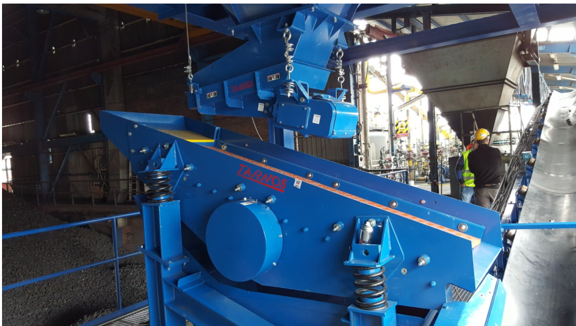
Ilustración 9. Descarga de la criba a la cinta transportadora
